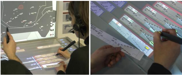
Figure 3: Dans Strip'TIC a) le contrôleur peut interagir avec le stylo Anoto sur l'image radar, les strips et le tableau, b) chaque strip papier est associé à un strip virtuel affiché en dessous, qui affiche les mêmes informations. Le système projette des informations dynamiques par dessus les strips physiques et virtuels, ainsi que sur le tableau.
