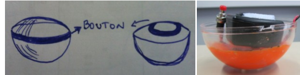
Figure 12. Illustration de l'emplacement possible de boutons circulaires (droite) et prototype fonctionnel intégrant un capteur magnétique 3D et un bouton simple.
